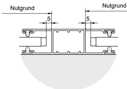
Horizontalschnitt zweiteilige Anlage
