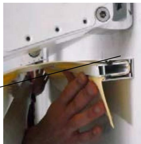
**13) Einsetzen der Wasserlippe in der Fallschiene**
