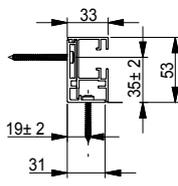
Kompakte Führungsschiene 33 x 53 mm, rückseitig glatt (Optik bei Leibungsmontage)
