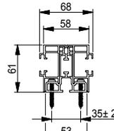
Fassaden-Doppelführungsschiene 58 x 61 mm. Als Ersatz der Standard Führungsschiene, ohne Mehrpreis.
