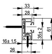
Fassadenführungsschiene 28 x 61 mm
