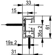
Standardführungsschiene 33 x 61 mm, schlagregendicht
