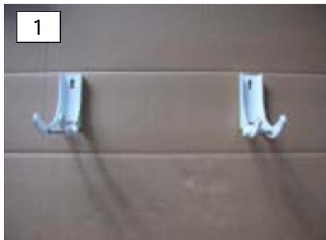
L'entraxe de fixation des supports muraux correspond aux dimensions de fabrication du verrou +6 cm (voir fig. : 1.2 et 1.3).
