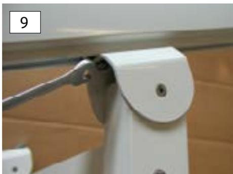
À l'aide d'une clé de 13 mm, serrez des deux côtés du logement (en haut/en bas).
