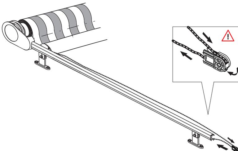
3. Seillänge und Knoten überprüfen (beidseitig 30 – 35 cm von Kante Bodenprofil, Seilende darf max. 1-2 cm nach dem Knoten überstehen, aber auch nicht weniger)
