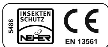
Les produits soumis à la Directive Machines comme par ex. la moustiquaire enroulable électrique Neher, doivent également être dotés d'une plaque signalétique.
