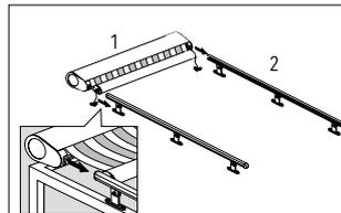
Fissare le guide premontate con i distanziatori. Inserire l'intera unità motrice nelle guide. Portare il telaio nella posizione corretta e allineare le guide.
