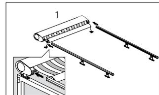
Fissare l'unità motrice con i distanziatori. Montare i distanziatori delle guide e inserire le guide preconfezionate nell'unità motrice, allinearle e fissarle.
