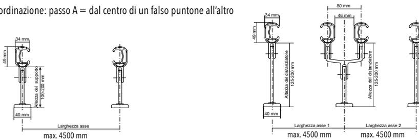
\*\* Misura ordine e base di calcolo è la **lunghezza della sottostruttura**. La sporgenza effettiva viene calcolata di fabbrica in base all'inclinazione del tetto e all'altezza dei distanziatori. Il tappo non è compreso nella sporgenza, ma esce di 40 mm.
